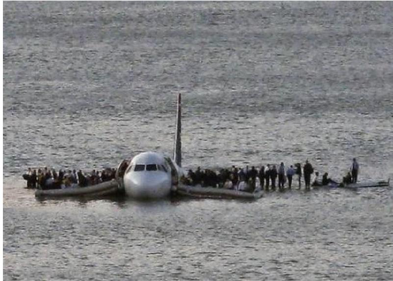
*L'adresse du pilote a consisté à arriver près de l'eau avec la vitesse minimale pour réduire l'impact, puis à toucher avec l'arrière du fuselage, enfin à laisser tomber doucement l'avion.*
